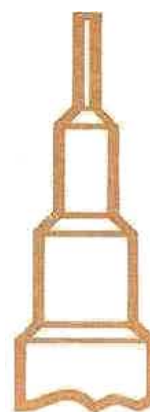
Eje motor en su zona de contacto con el elemento de transmisión para cambiar velocidades
