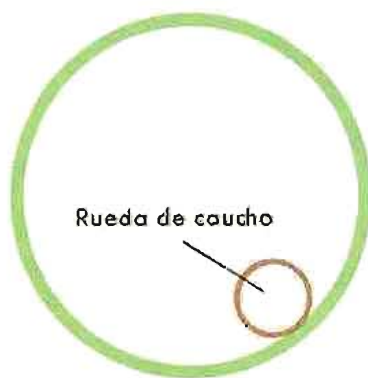
Arrastre por rueda de caucho unida directamente al eje del motor
