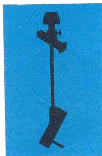
Brazo Dual. El equilibrio lateral se consigue porque parte del cabezal está desplazado hacia la derecha.
